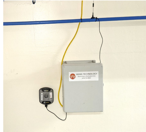
Vibration monitor installed in basement 安裝在地下室的振動監測器
